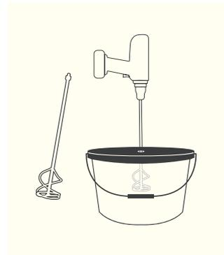
Rührstab an Bohrmaschine – nur bei geschlossenden Deckel mischen
