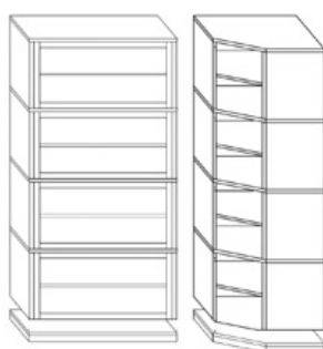
Korpuselemente 34, Höhe je Element 419 mm, Tiefe 347 mm.
