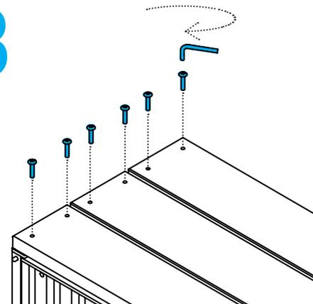
Abschließend die 12 Schrauben von oben in die Bretter einstecken und mit den Montagebügeln verschrauben.
