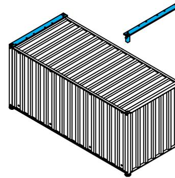
Zunächst die beiden Montagebügel von oben in die Röhre des CONTAINER DS einsetzen.
