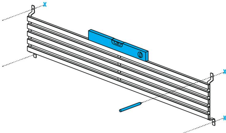
Wir empfehlen den Aufbau zu zweit. Vor der Montage den Winkel des Kopfteils beachten: Der Abstand zur Wand wird im montierten Zustand von unten nach oben kleiner. Das Kopfteil wie gewünscht positionieren, mithilfe einer Wasserwaage ausrichten und die vier Bohrlöcher anzeichnen.
