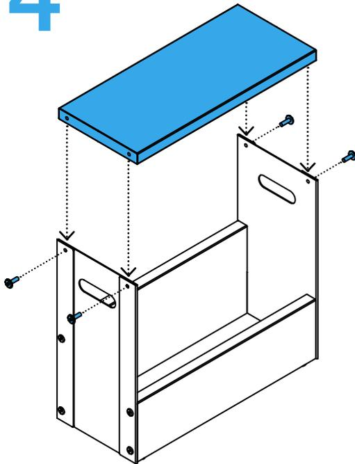
Sitzfläche zwischen den Seitenblechen positionieren und mit den verbleibenden vier Schrauben fixieren.
