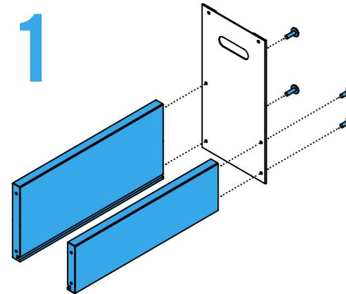
Die Vorder- und Rückblende an das Blech anschrauben. Die Faltungen des Blechs weisen dabei nach außen und die Nuten im Holz nach innen.
