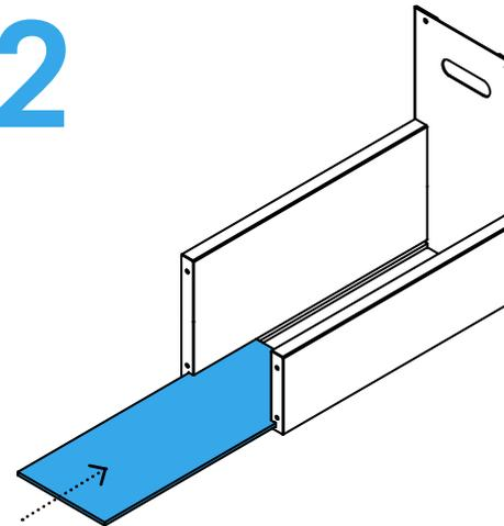
Den Boden in der Nut der Vorder- und Rückblende positionieren und bis zum Blech hineinschieben.
