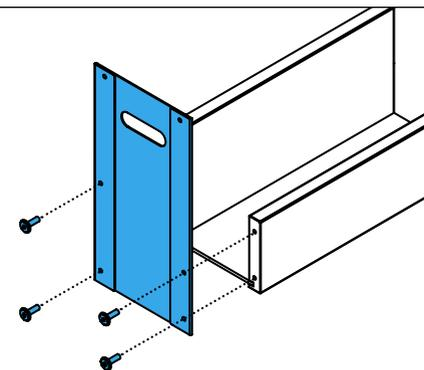
Das zweite Seitenblech wie in Schritt 1 anschrauben.
