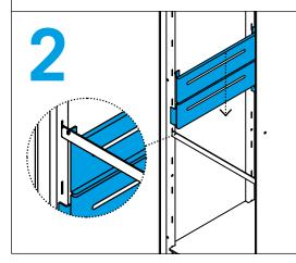
Die Auszugbleche zwischen die Fachbodenträger einhängen. Das Auszugblech mit der seitlichen Lasche wird scharnierseitig in den dritten Schlitz im Fachbodenträger eingesetzt.
