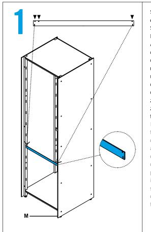
Setzen Sie die Fachbodenträger ein, indem Sie diese auf einer Seite des Pfostens in die länglichen Aussparungen bis zum Anstoß einstecken. Nun auch die andere Seite des Trägers in die gegenüberliegende Aussparung einfügen. Die Bodenträger müssen wie auf der Abbildung dargestellt ausgerichtet sein – die Seite des Trägers mit nur zwei Schlitzen auf einer Seite zeigt immer zur Seite des Pfostens "M".
